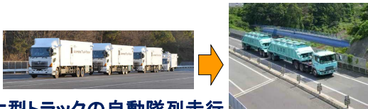
大型トラックの自動隊列走行 (車間距離4m)
