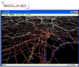
●交通シミュレータ(TS) 交通量の発生・集中管理、 渋滞などの交通状況を 再現
