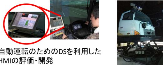
自動運転のためのDSを利用したHMIの評価・開発
