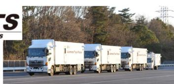
車車間通信技術により車間4mの自動隊列走行を実現(完全自動)
