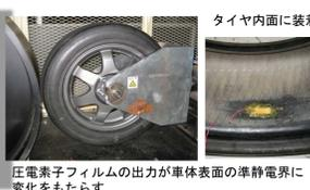
圧電素子フィルムの出力が車体表面の準静電界に変化をもたらす
